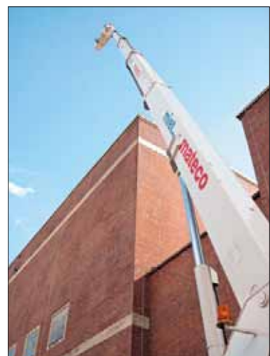
Die mateco-Arbeitsbühne LT 350 überwindet die Einsatzhöhe von 35 Metern spielend.
