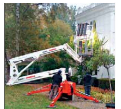
Geringe Bodenbelastung – leichte Bühne: Die XTG 149 ist ideal für diesen Einsatz.
