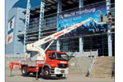
Mit Hilfe der LT 350 K D wurde das Riesposter von O 2 schnell und effektiv montiert.
