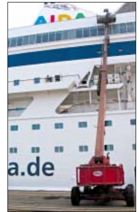
Mit der Teleskop-Arbeitsbühne konnte an höchster Stelle gestrichen werden.
