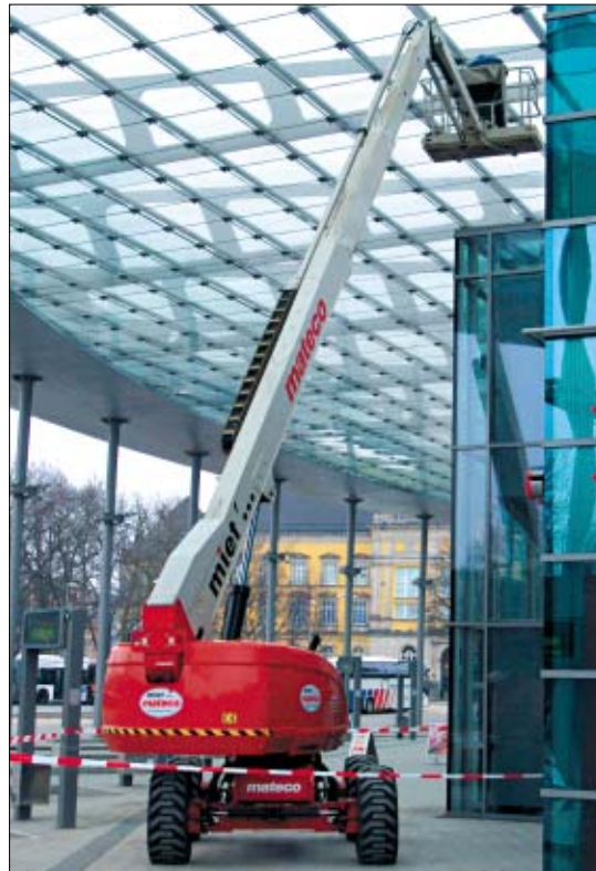
Für den Korbarm sind Fassadenvorbauten kein Hindernis.
