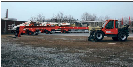
Lasten von 1.300 kg können seitlich bis zu 9,20 m gehoben werden (Abstützung ausgefahren).
