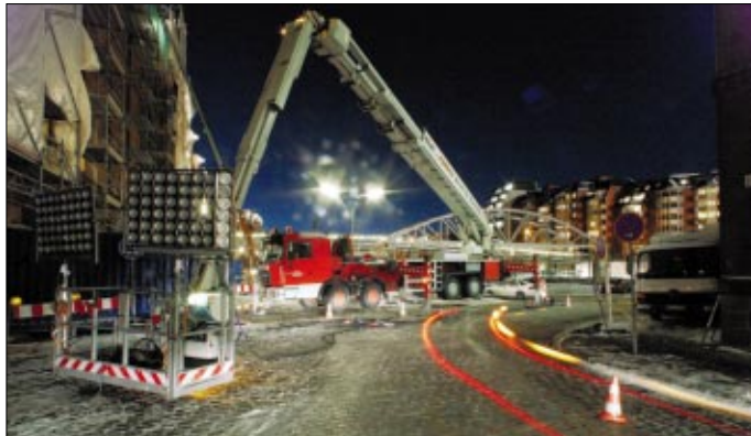
LKW-Arbeitsbühne LT 550 K D/E 380V 4x4 – mit 55 m Arbeitshöhe und 440 kg Traglast im Korb – bestückt mit zwei gewichtigen Lichteinheiten. Fotos: Thorsten Baering
