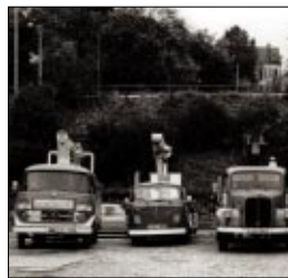
(v.l.n.r.): LKW-Gelenk-Arbeitsbühnen (11 m Arbeitshöhe, Ruthmann/Mercedes-Benz; 11 m Arbeitshöhe, Ruthmann/Volkswagen), LKW-Gelenk-Teleskop-Arbeitsbühnen (13 m Arbeitshöhe, Ruthmann/Mercedes-Benz; 15 m Arbeitshöhe; 15 m Arbeitshöhe).
