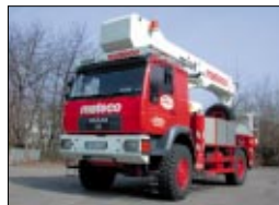
LKW-Arbeitsbühne LT 350 K D, 35 m Arbeitshöhe bei nur 18 t zul. Gesamtgewicht, als Allrad- oder Straßenversion erhältlich.
