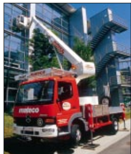
LKW-Arbeitsbühne LT 260 K D/LT 300 K D, 26 bzw. 30 m Arbeitshöhe bei 7,49 t zul. Gesamtgewicht, bei Fensterreinigungsarbeiten.
