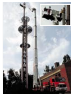
LKW-Arbeitsbühne LT 880 K D mit 88 m Arbeitshöhe bei Arbeiten an einem Mobilfunkmast in Dortmund.
