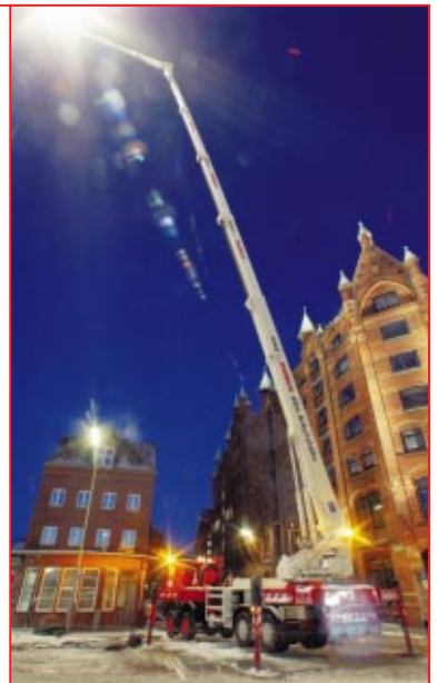
LKW-Arbeitsbühne LT 620 K D/E 380V 4x4 – mit 62 m Arbeitshöhe und 400 kg Traglast im Korb – als Lichtmast für die Set-Ausleuchtung.
