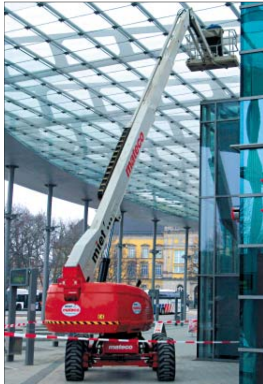
Für den Korbarm sind Fassadenvorbauten kein Hindernis.
